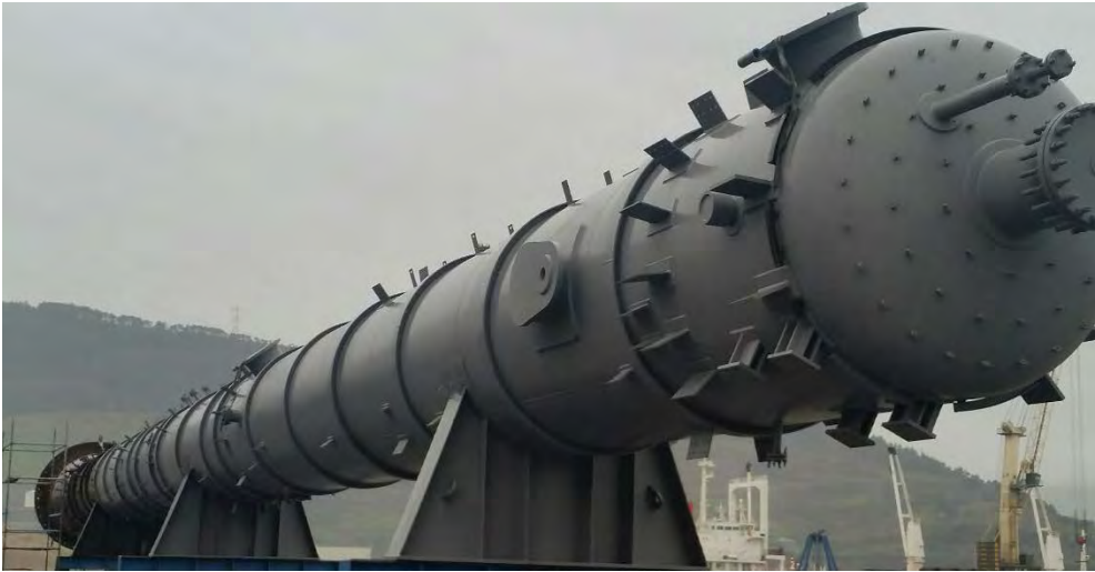
SACYR FLUOR – реактор гидроочистки – обшивка SA387 Gr11 Cl2 + нерж. сталь 321
